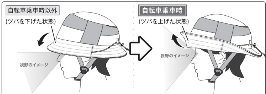
使用用途(自転車乗車時以外、自転車乗車時)に合わせて、後頭部の紐の固定位置を調整し、ツバの角度の調整をおこなってください。
