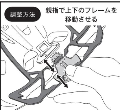
ヘッドレストの幅を変えるときは、それぞれのフレーム位置がAもしくはBの同じ位置に揃っているように設定してください。
