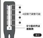
アジャスターの固定部付近をしっかりと持ち 11 、4段階のい ずれかに移動させます。 図2
