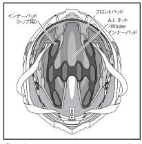
④A.I.ネット/Winterインナーパッドの穴から露出しているマジックテープヘトップパッドを正しい位置に取り付けます。
