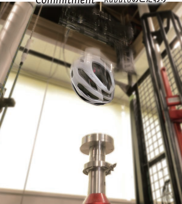
衝撃吸収試験の様子
