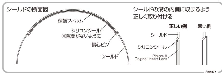
③シールドをヘルメットに取り付けて、Pinlock® Original Insert Lensのシリコンシールが全てに渡ってシールドに密着しているかを確認します。このとき、隙間が見られる場合は、「Pinlock® Original Insert Lens・取り付け後の調整」を参照のうえ、調整してください。
