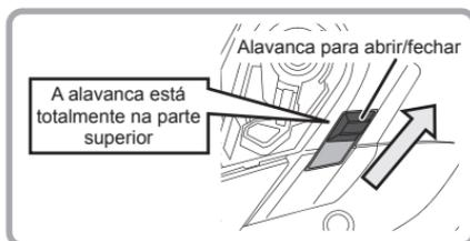
2. Pressione a extremidade da pala interior em direção ao orifício de fixação no capacete até fixar fixo.
