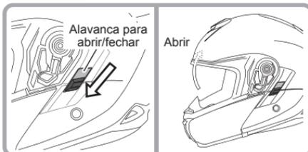
Deslize a alavanca para baixo para abrir a pala interior para o sol.
